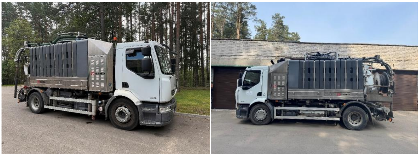
34 pav. Hidrodinaminis automobilis „Renault Midlum 280.18“
